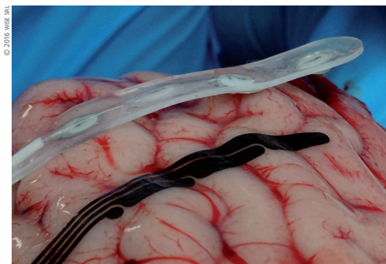
Confronto tra una griglia corticale di WISE (in basso) e una griglia commerciale (in alto) su un cervello bovino
